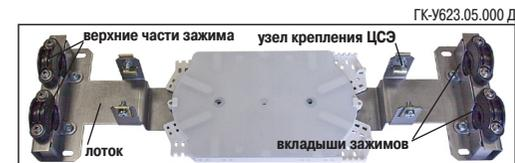
5 Закрепить ОК в зажимах лотка, располагая установленный при монтаже ОК соединитель таким образом, чтобы его шпилька и гайка располагались вне пределов зоны зажима, к центру муфты (рисунки "а" и "б").
