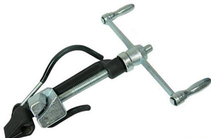
Применяются для монтажа металлической ленты при креплении на столб промежуточных крюков на деревянных и бетонных опорах. Клещи оснащены специальным ножом для деления монтажной ленты на необходимые отрезки. Предназначены для натягивания ленты и прочего натяжного или поддерживающего оборудования при прокладке коммуникационной линии на опорах электропередач, нагрузки.
