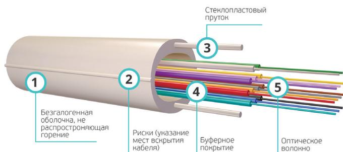
Оптический кабель типа ОК/Д2-Т2...
