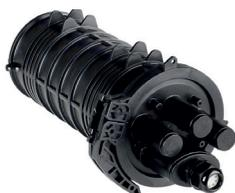
**Тупиковая муфта МКО-К6/А** предназначена для монтажа подвешного магистрального кабеля с абонентскими ответвлениями самонесущих дроп-кабелей малого диаметра. Способ герметизации корпуса с оголовником механический. Осуществляется при помощи эластичной кольцевой прокладки и армированного пластикового хомута с самозатягивающимся замком. Замок хомута сконструирован таким образом, что при открывании защелка трансформируется в рычаг, обеспечивающий легкое снятие хомута с муфты.
