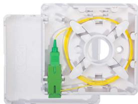
**Абонентские оптические розетки серии ШКОН-ПА-1** предназначены для размещения в офисах и жилых помещениях. Емкость ШКОН-ПА-1 - 1 порт SC или LC. Оптические кабели разделяются и фиксируются на основании корпуса. Волокно сваривается с пигтейлом, КДЗ закрепляется в ложементе. Возможно использование механических соединителей типа Fibrlok. Адаптер устанавливается в одно из посадочных мест на основании корпуса.
