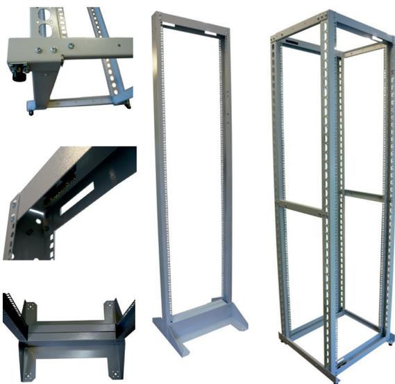
Размеры стоек телекоммуникационных соответствуют стандарту 19». Стойки имеют электрическое заземление. Фиксация к полу производится четырьмя анкерными болтами. Стойка поставляется в разобранном виде. Стойка может эксплуатироваться при температурах от минус 40 °С до плюс 70 °С и относительной влажности окружающего воздуха до 80% при плюс 25 °С. Цвет стойки - серый, RAL 7035 или 7032 шагрень.
