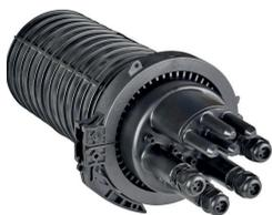
**Муфта-кросс МКО-ВЗ** предназначена для использования в сетях FTTH/PON с установкой модульных планарных оптических разветвителей 2го касада, для монтажа оптических кабелей (ОК), прокладываемых (подвешиваемых) на открытом воздухе и внутри технических помещений (чердаках, подвалах). Выполнена на базе стандартного корпуса муфты ВЗ и имеет пыле-влагозащищенную тупиковую конструкцию (ввод и вывод ОК производится с одной стороны). Материал корпуса - пластик.
